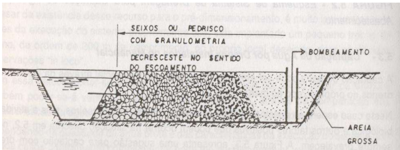
FIGURA 5.4 – Esquema de captação Direta com Pré-filtro Grosseiro (27)
