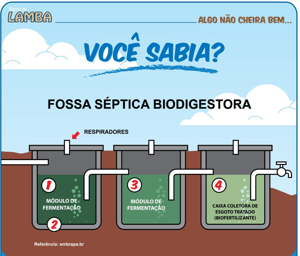
A Fossa séptica biodigestora é uma tecnologia desenvolvida pela Embrapa, com o objetivo de tratar o esgoto do vaso sanitário das residências isoladas (distantes dos centros urbanos). Por ser mais utilizada na área rural (sem acesso à rede coletora de esgotos), essa tecnologia permite o tratamento das "águas negras" que, se lançadas de forma inadequada, causam impactos no meio ambiente e na saúde da população.
