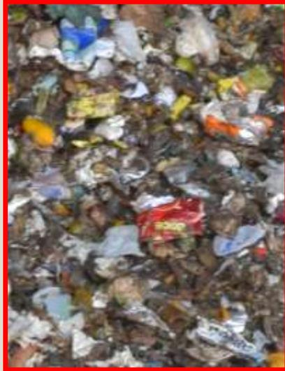
Grande quantidade de materiais plásticos na fração orgânica, consequência de uma separação insuficiente - inviabiliza o seu uso no biodigestor.
